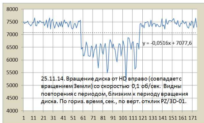
Рис. 8. Запись сигнала Прибора от соосного правого вращения диска №2, совпадающего с направлением вращения Земли, в полярной установке. Скорость вращения 0,1 об/сек.
